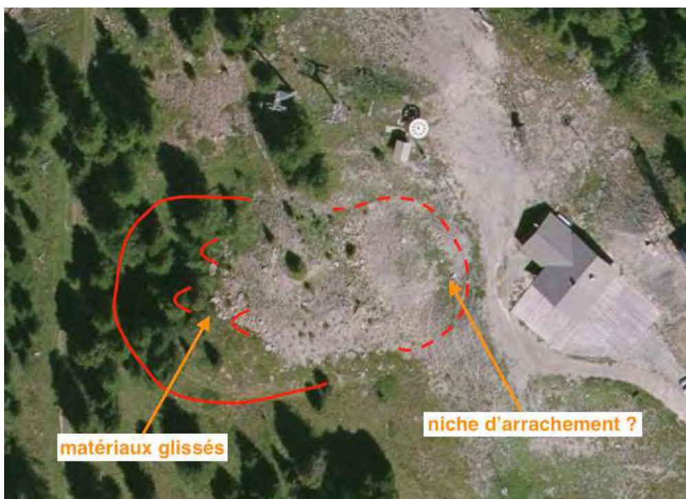
Figure 13 : localisation de la zone glissée près de la gare amont
